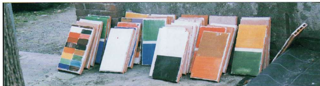
34-37. Preparazione delle tinte della tavolozza dei colori delle facciate del Castello, in base ai campioni d’intonaco, e loro riproduzione a calce a secco su pannelli e a fresco su tavelle in cotto.
