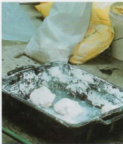
Lezione in sito sulla calce, mediante dimostrazione pratica di estinzione di alcune zolle di calce viva da trasformare in grassello
