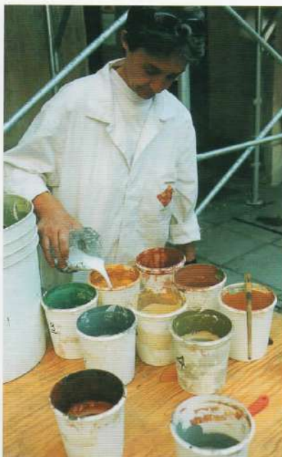
Realizzazione del modello della tavolozza dei colori su pannello, con i campioni di intonaco colorato di riferimento confrontati direttamente con i colori della tavolozza
