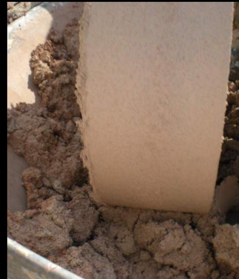
Preparazione dell'intonaco al cocchiopesto in laboratorio, mediante la "molazza"
