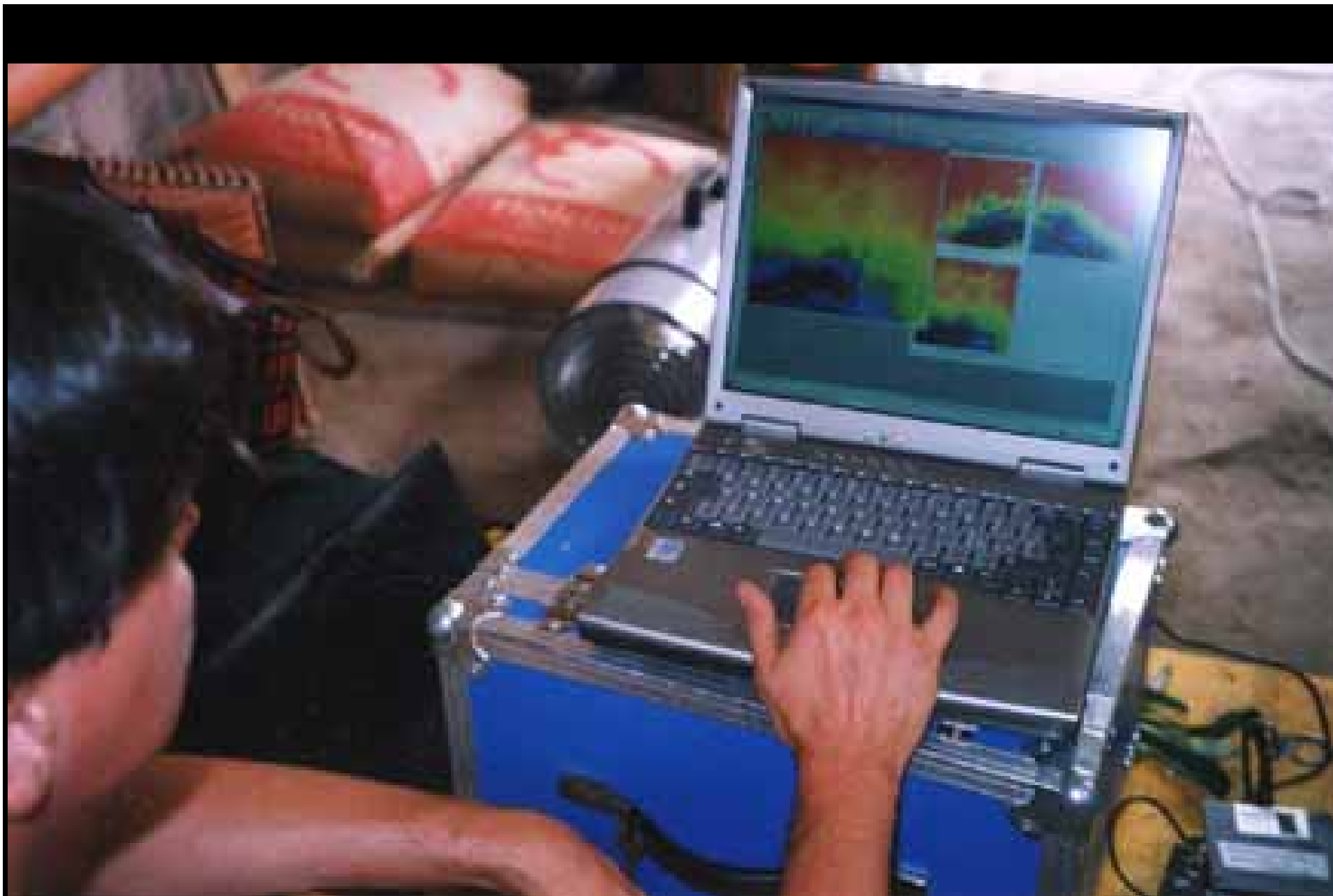
Impostazione dell'indagine termografica per la determinazione dell'umidità nelle murature della Cappella, realizzata dal Laboratorio Rankover
