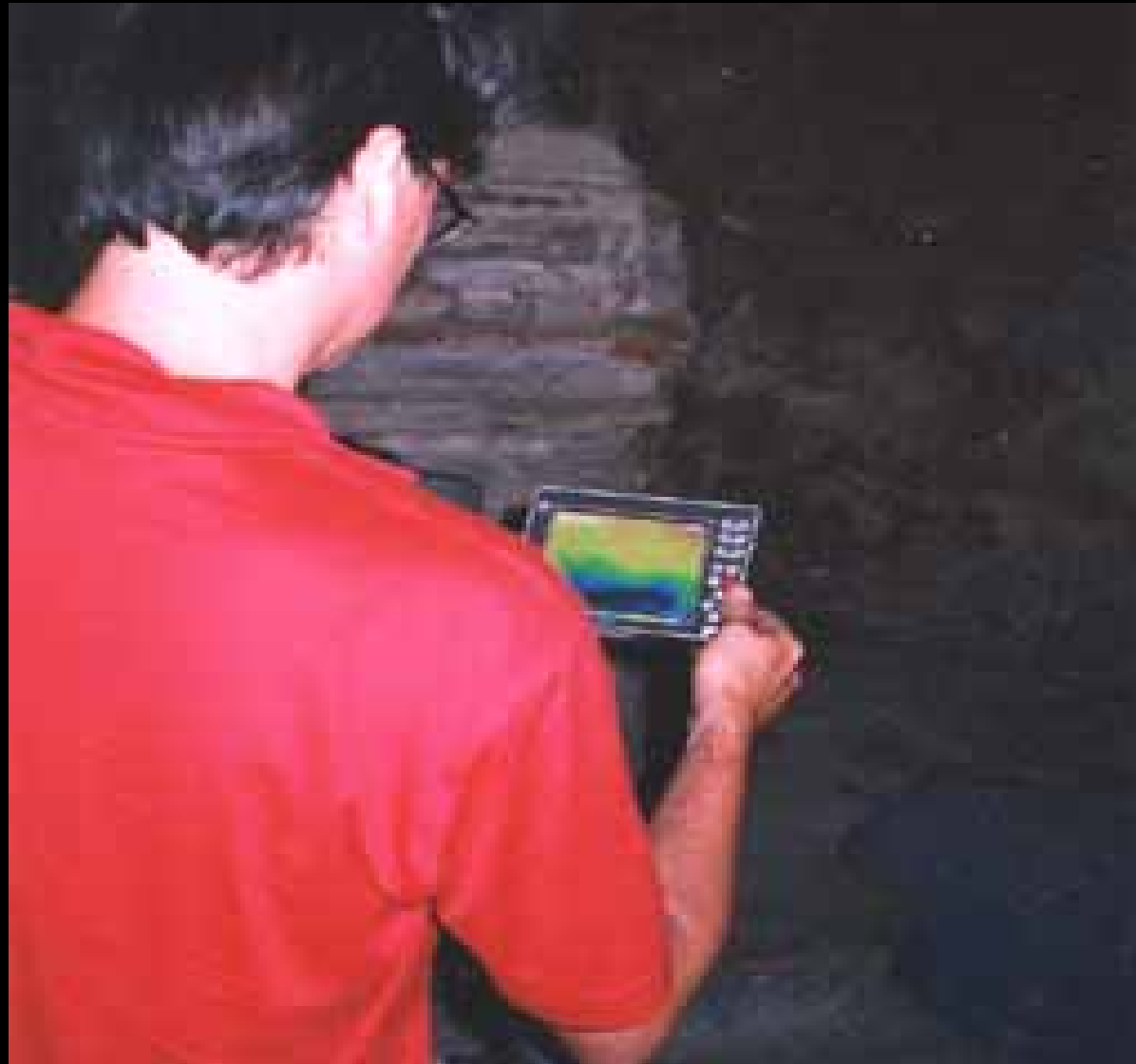
Particolare dell'indagine termografica per l'analisi qualitativa dell'umidità
