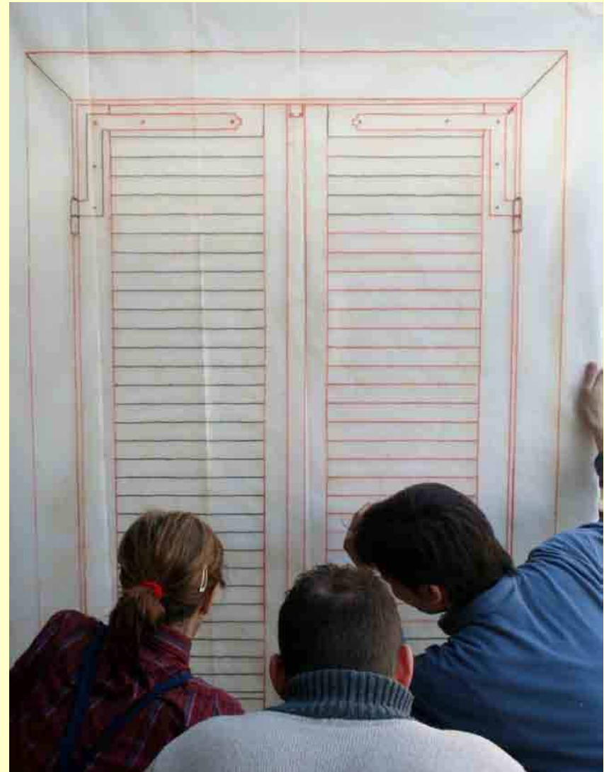
Ricostruzione, in Laboratorio, degli spolveri delle persiane in trompe-l'oeil, da riprodurre sulle facciate del Municipio
