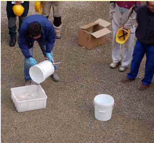
Saggio di di spegnimento della calce, il materiale base impiegato nel Corso per gli intonaci e le coloriture
