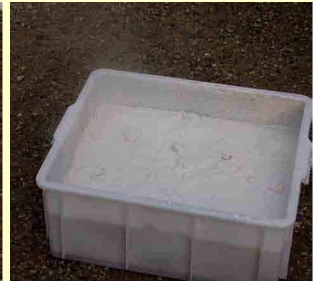
Saggio di di spegnimento della calce, il materiale base impiegato nel Corso per gli intonaci e le coloriture
