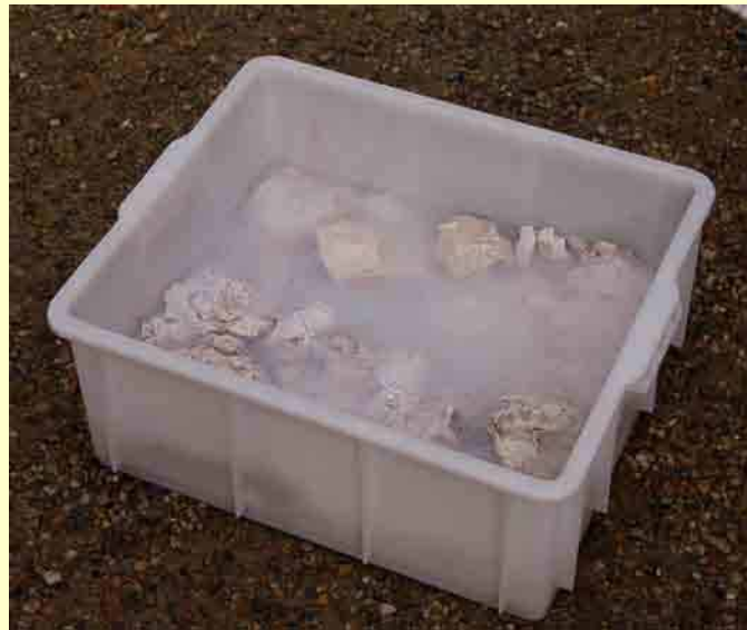
Saggio di di spegnimento della calce, il materiale base impiegato nel Corso per gli intonaci e le coloriture
